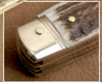
Schönheitsfehler: Schief geschliffene Zierrillen an einem der beiden Backen.
